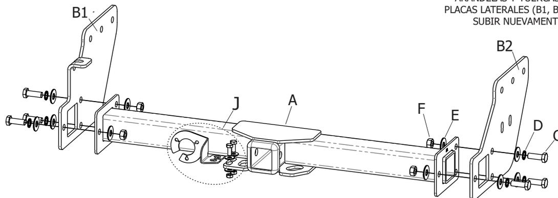
COLOCAR EL TRAVESAÑO Y SUJETARLO CON LOS TORNILLOS, ARANDELAS Y TUERCAS SUMNISTRADAS. AJUSTAR LAS PLACAS LATERALES (B1, B2 Y B3) COMPLETAMENTE. LUEGO SUBIR NUEVAMENTE EL NEUMÁTICO AUXILIAR
